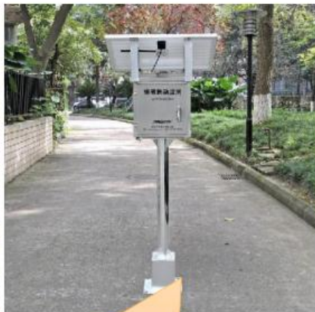
太阳能发电装置供电，支持连续15个阴雨天供电
